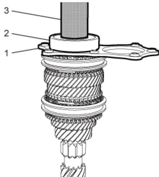
**注意:**安装时注意输入轴和主轴轴承板的方向。有突起的一侧向上。
