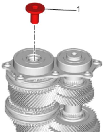
3.将输入轴和主轴总成放置在DT-52102齿轮轴总成轴承安装工具上，在助手帮助下安装输入轴后轴承锁紧螺栓，并紧固至145 N•m（107 lb ft）。
